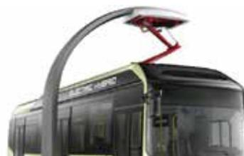
Recharge des Trambus assurée à chaque terminal par des infrastructures de recharge rapide par pantographe (voir ci-dessus).
