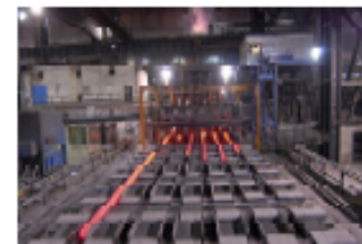
Sortie des billettes (produits semi-finis de section carrée - 130/140/160 mm - pouvant mesurer de 8 à 13 m de long)
