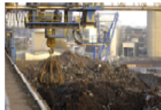
Stockage de la ferraille dans 2 parcs d'une capacité totale de 55000 t.
