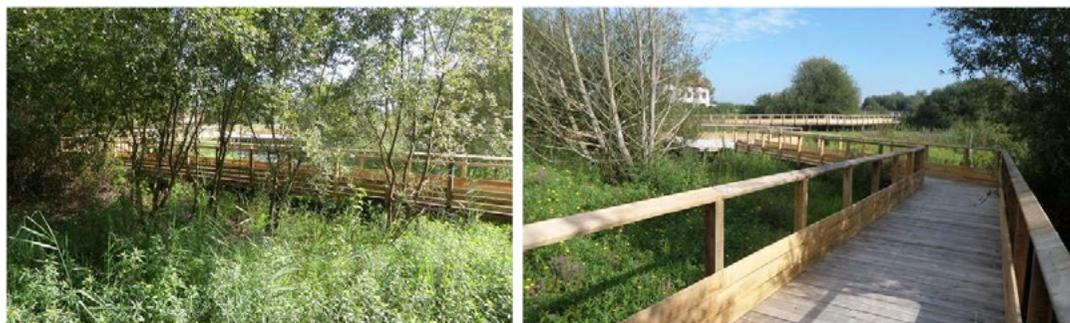
Version du chemin en ponton bois, largeur 3m, chemin en platelage bois, palissades de chaque côté, coût 1690 €/ml (offrant une continuité écologique et hydraulique + une protection du milieu contre les dégradations, nuisances et incivilités d'usage)
